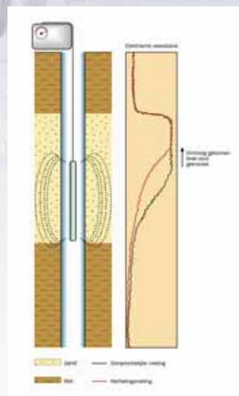
Schematische weergave van een elektromagnetische boorgatmeting op herhaling in een peilbuis met pvc wand.
