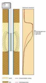
Schematische weergave van een elektromagnetische boorgatmeting op herhaling in een peilbuis met pvc wand.
