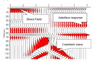
(d) Synthetic seismoelectrogram
