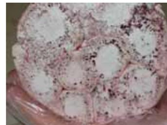
*Fig. 2 De onderkant van de kleilaag na uitvoeren van de proef. Het is duidelijk te zien dat het blauwe water in de klei gedrongen is. Bij de klei in lucht en olie is er nog ruimte aanwezig tussen de kleibrokken.*
