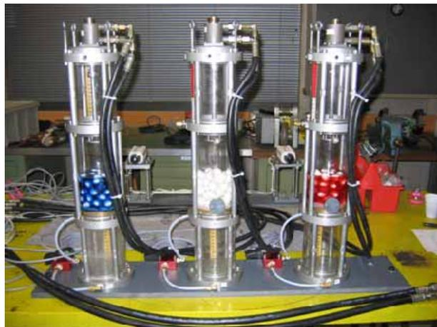
Fig. 1 De opstelling gereedgemaakt voor de eerste proevenserie, klei in (blauw gekleurd) water, lucht en (rood gekleurde) olie.
