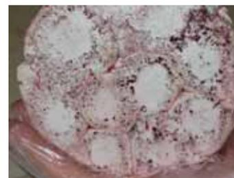
*Fig. 2 De onderkant van de kleilaag na uitvoeren van de proef. Het is duidelijk te zien dat het blauwe water in de klei gedrongen is. Bij de klei in lucht en olie is er nog ruimte aanwezig tussen de kleibrokken.*
