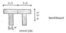
De grootste totale hoogte van de hoofdwand bedraagt ca. 33 m met een maximum kerende hoogte van ca. 20 m. Deze laatste komt tot stand door na fabricage van de wand en het aanspannen van de ankers de grond voor de diepwanden weg te baggeren. Bij de sterkte- en stijfheidsbeoordeling van het ontwerp speelt de bepaling van de in te voeren relevante grondparameters een hoofdrol.
